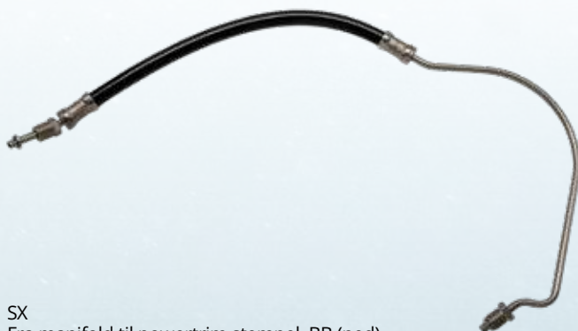
290, SP, DP, DPX Hydrauliklinje mellem både ældre firkantede og nye runde pt stempler foran. 290, 290DP, SP-A, SP-A1, SP-A2, DP-A, DP-A1, DP-A2, DP-C1, DP-D1, DP-S, DP-E, S DP-G, TSK DP-G, DPX-A, TSK, DPX-A, DPX-R, DPX-R 1.47, DPX-R 1.51, DPX-S, DPX-S1
