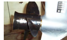
Bild 3 Att inte installera adapterringen lämnar ett gap som orsakar överdriven ventilation och dålig prestanda
