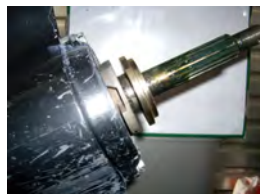
Bild 6 Original tryckbricka har inte tagits bort och delarna från XHS navsatsen Michigan Wheel propellern kommer inte att passa ordentligt.
