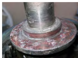
Med tiden kan tryckbrickan visas som en del av propelleraxeln . Det är fortfarande nödvändigt att ta bort tryckbrickan när du monterar en XHS propeller.
