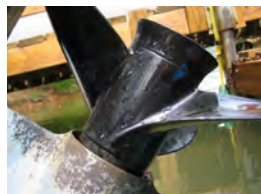
Bild 4 Vortex "C" serien (3-3/8") Propeller installerad på en V4 (4-1/4") växelhush. Resulterar i dålig prestanda och överdriven ventilation. Vortex Serie "B" (4-1/4") propeller bör användas.
