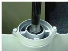
Bild 5 Propelleraxeltaper är synlig, vilket indikerar OEM tryckbricka har tagits bort. Tryckbrickan från XHS navsatsen kan nu monteras.
