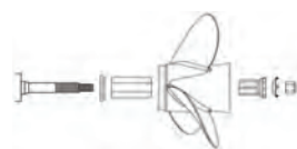
Bild 8 Den främre tryckbrickan måste installeras först, skulle detta missas så kan stora skador uppstå på växelhushet som följd.
