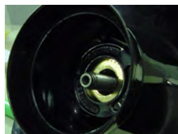
Den bakre tryckbrickan är inte korrekt monterad och propellern kommer att ramla av vid försök att köra med denna monteringen.
