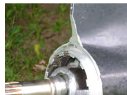
Utan en främre tryckbricka tar propellern i växelhushet Propellern kommer att fortsätta att gå framåt på axeln vilket orsakar allvarliga skador på växelhushet.
