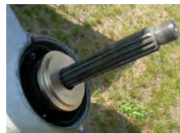
Bild 7 Den främre tryckbrickan är konisk och passar på axeln, när den är korrekt installerad skall Art.nr på brickan synas.
